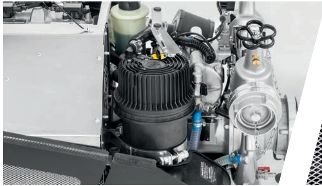
Wassergekühlter 2-Zylinder 4-Takt-Ottomotor mit Trockensumpfschmierung
