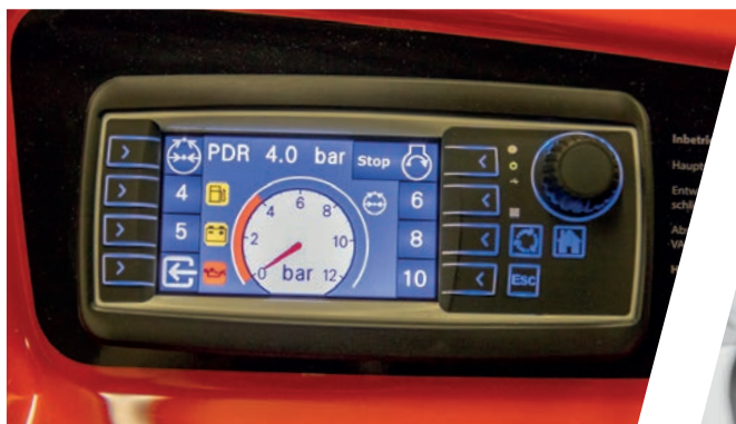
Pumpendruckregelung mit Druckvorwahltasten
