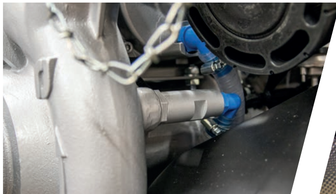
Serienmäßiges mechanisches Thermostatventil
