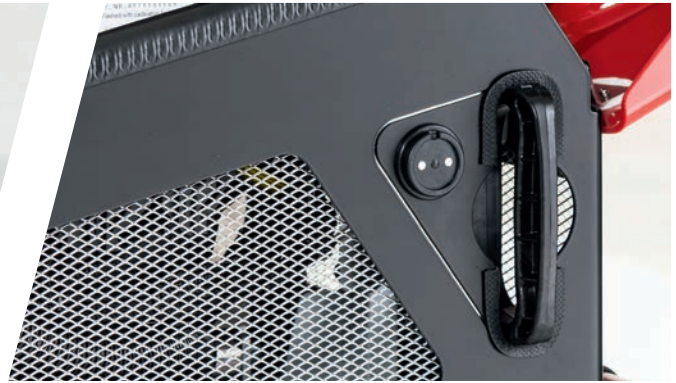
Notstartvorrichtung und magnetische Ladesteckdose
