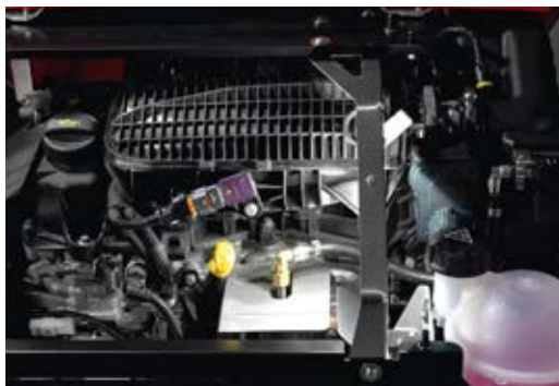
Beleuchteter Wartungszugang für Öl und Kühlflüssigkeit
