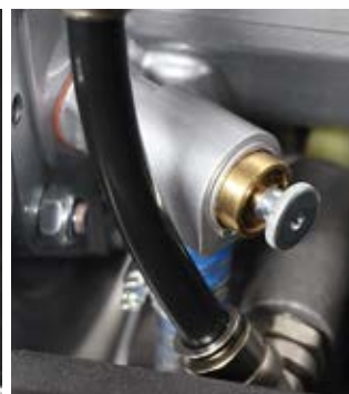
Mechanisches Thermostatventil mit Spülfunktion serienmäßig
