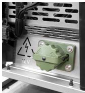
NATO-Fremdstartsteckdose 12 V DC und OBd II Diagnosestecker
